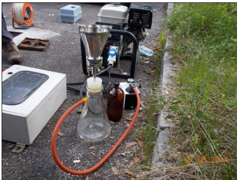
Foto 2: dettaglio strumentazione per filtrazione da campo
